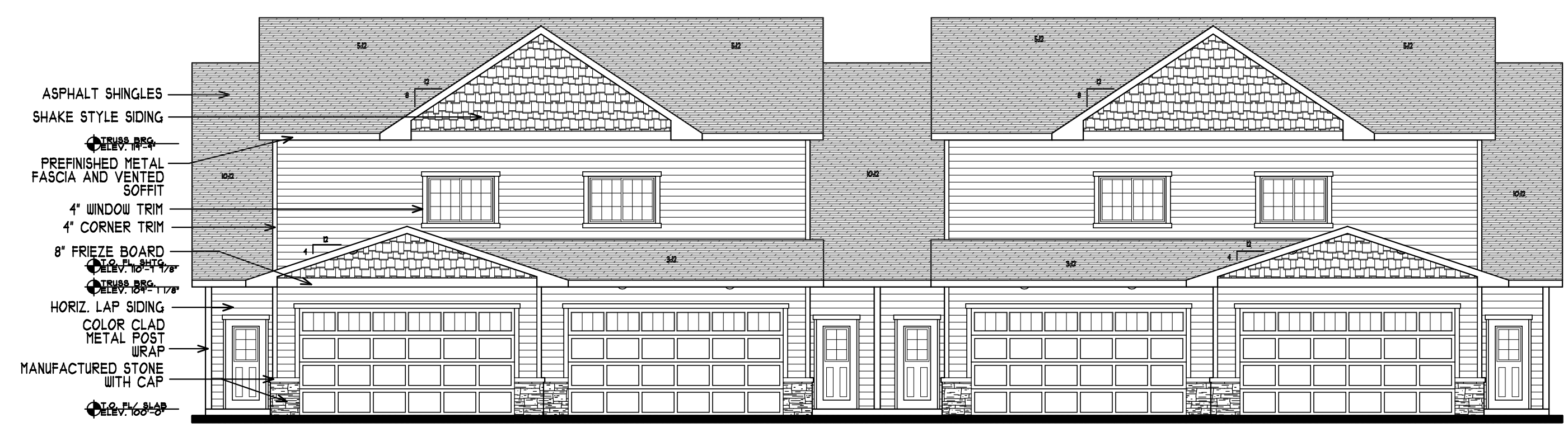
FRONT ELEVATION - BLDG. "A" SCALE: 1/8" = 1'-0"
