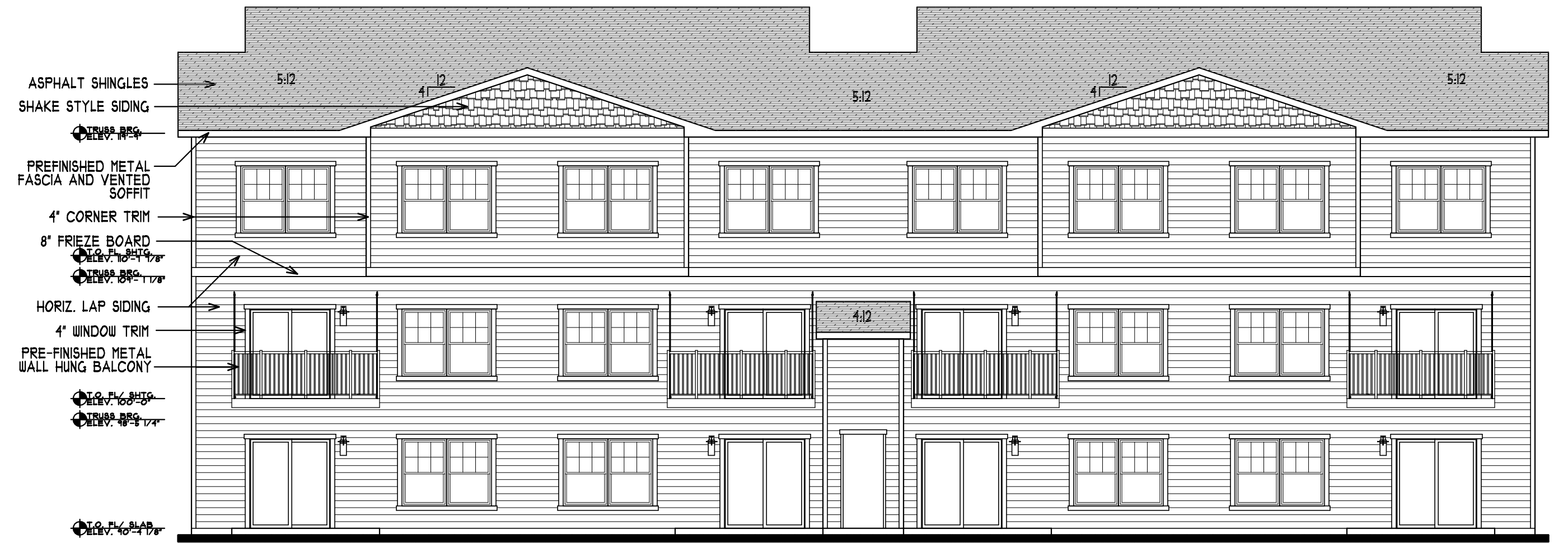
REAR ELEVATION - BLDG. "B" SCALE: 1/8" = 1'-0"
